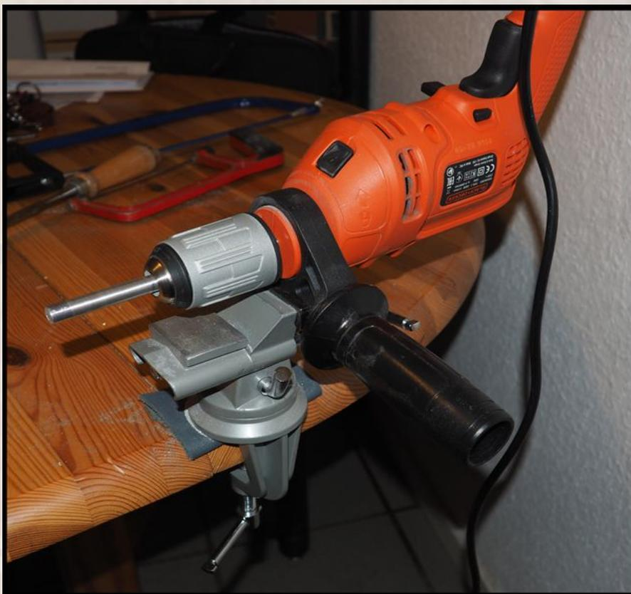
Jetzt lässt man die Maschine laufen und hält vorsichtig die Feile an den Stab. (***bitte Schutzbrille tragen***) Es muss gleichmäßig Material abgenommen werden. Immer wieder hält man die Maschine an und prüft ob der Stab bereits leicht in das Rohr läuft. Der Stab darf ruhig etwas dünner sein als der Innendurchmesser. Locker ist besser als zu stramm.
