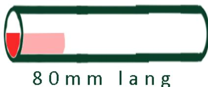
Jetzt klebt man das bereits abgeflachte 15mm lange Teil des Rundstabes in das Rohr. Schlägt es vorsichtig mit einem Hammer ein, bis es außen bündig sitzt.
